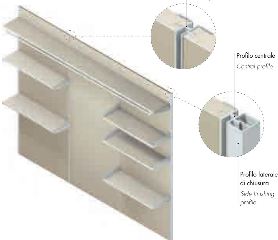
Il profilo centrale DA23 permette l'unione degli schienali, completato con i profili DA25 diventa il montante laterale di finitura.
