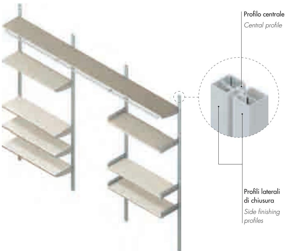
Il profilo centrale DA23 viene completato dai profili laterali DA25 che nascondono le viti di fissaggio.
